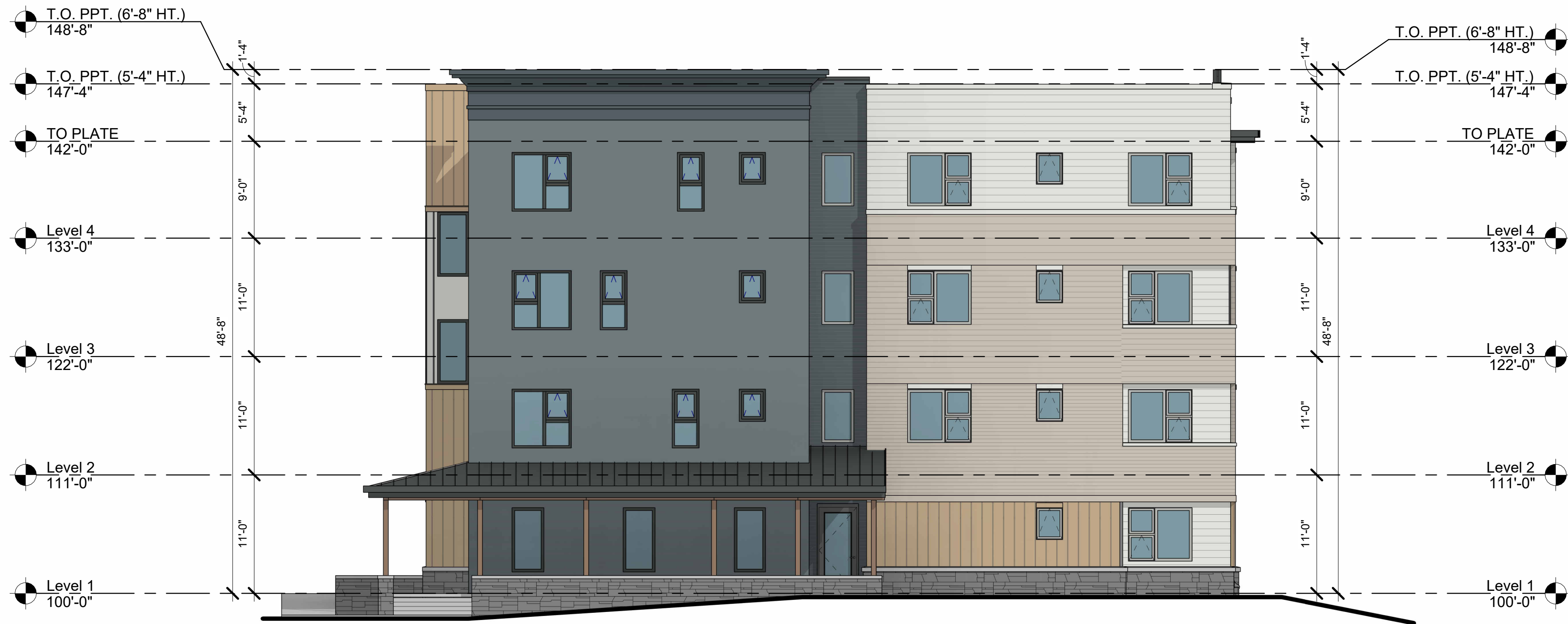
2 BLDG 1 - RIGHT ELEVATION SCALE: 1/8" = 1'-0"
