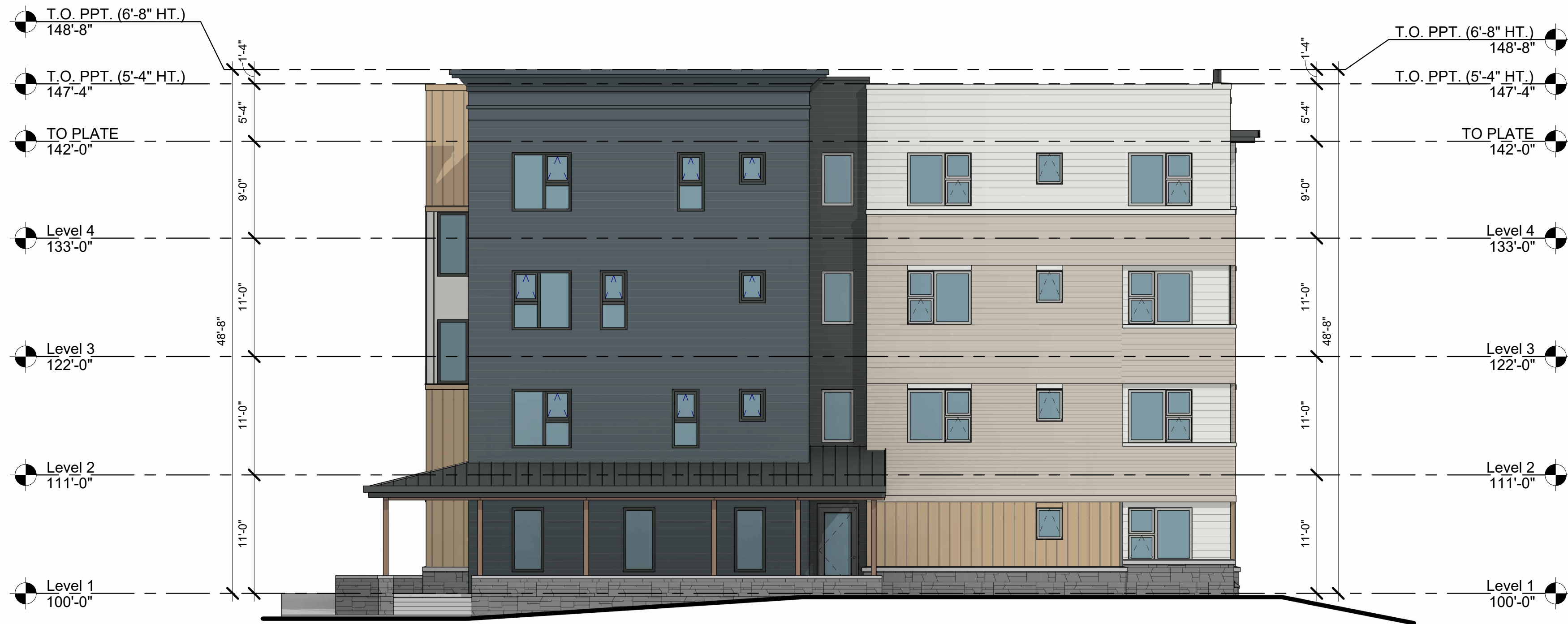
2 BLDG 1 - RIGHT ELEVATION SCALE: 1/8" = 1'-0"
